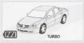
Wenn auf dem Bildschirm „TURBO“ angezeigt wird, läuft die Motorenkühlungsfunktion. Der Motor läuft für zwei weitere Minuten nach dem er schon gestoppt wurde, dadurch wird der Motor gekühlt. Die Funktion sollte nach längeren Fahrten und bei hohen Temperaturen genutzt werden.
